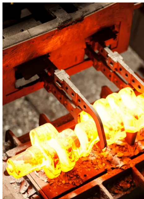
Herstellung einer Lkw-Kurbelwelle
